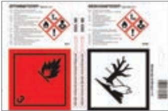
Etiketten zur Kennzeichnung von Kraftstoffkanistern
